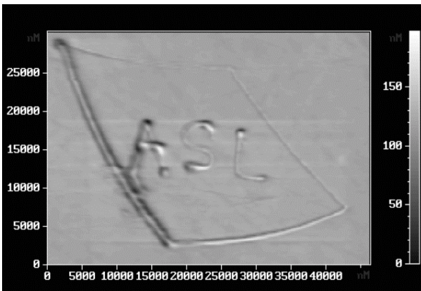
Fig. 7. Litographie manuelle à l'aide de l'interface haptique (échelle en nm)
